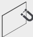
Los paneles deben ser ferrosos, planos y tener un espesor mínimo de 1 mm. Recomendamos el uso de paneles de Ronda Design para una mejor funcionalidad.
